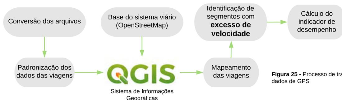
**Figura 25** - Processo de tratamento dos dados de GPS
