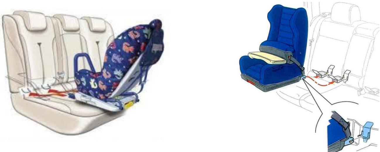
Figura 2 e 3 - Demonstração das garras fixadas na estrutura do veículo
