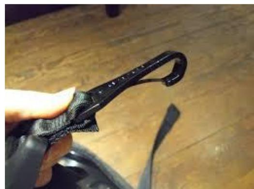
Figura 32 – Modelo de trinco utilizado no Top Tether e em alguns modelos de dispositivos com Latch.
