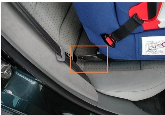
Figura 4 - Extensão do gancho que é fixado na estrutura do veículo
