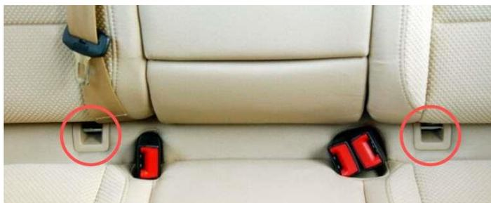
Figura 6 - Alça do ISOFIX fixada na estrutura do banco traseiro
