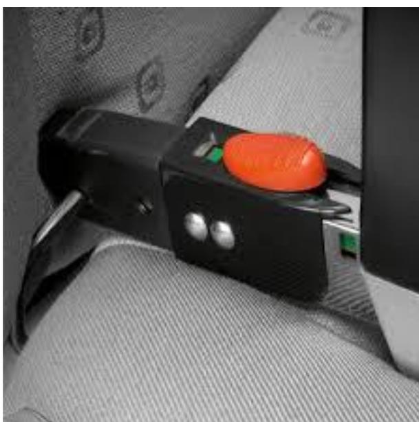
Figura 9 - Além da faixa pode ser encontrado no mercado dispositivos com marcações em verde, para informar que a fixação está ok
