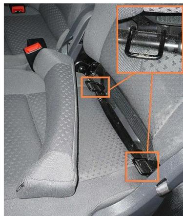
Figura 5 - Alça do ISOFIX fixada na estrutura do banco traseiro
