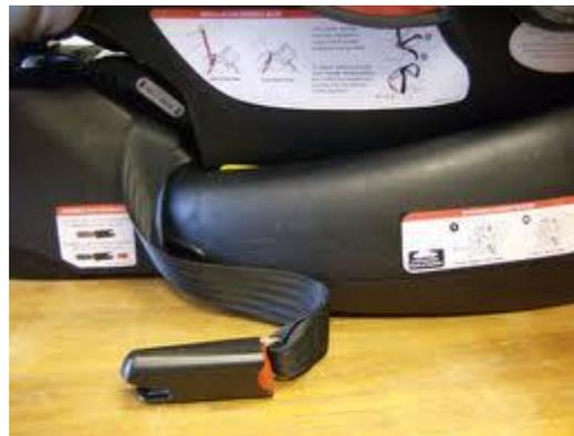
As figuras 29 e 30 demonstram um dispositivo com o tipo de fixação Latch, com os trincos semelhantes ao ISOFIX
