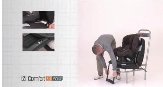
As figuras 25 e 26 demonstram a fixação completa do dispositivo. Primeiro é fixado as travas ISOFIX (note na figura 25 que após a fixação o botão apresenta a faixa verde, indicando que o encaixe está ok), posteriormente a base fast fix (ou Leg Support) é ajustada ao chão, que seria o assoalho do veículo.
