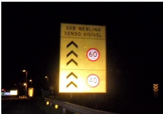
Foto noturna com chuva, iluminação dos faróis altos, de dentro do veículo, parado no acostamento. Situação: rodovia de duas pistas. A placa, com alto grau de refletividade pode ser visualizada com nitidez em diversas situações climáticas.
