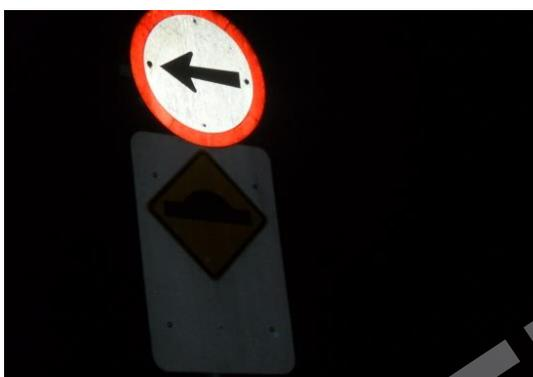
Foto noturna, Iluminada pelos faróis do veículo, tirada de dentro do veículo, parado no acostamento. Situação: a sinalização retro refletiva tem identificação completa, sendo que a não refletiva apresenta-se escura e de difícil identificação, não tendo o contraste necessário para garantir as condições de condução segura.
