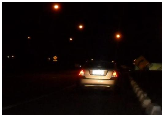
Fotos noturnas, iluminadas pelos faróis do veículo. Situação: Em avenidas com baixos níveis de iluminação pública, as placas produzidas em material não refletivo são difíceis de visualizar e identificar.
