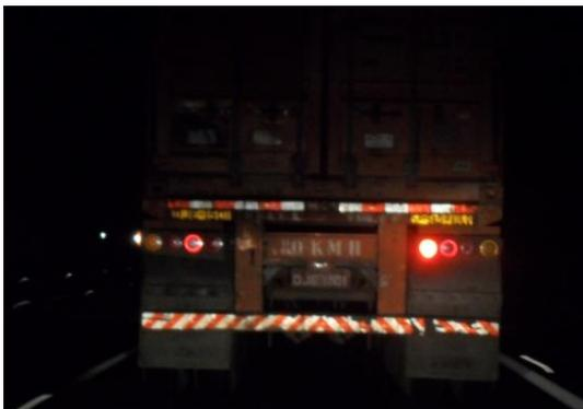
Foto noturna, iluminado pelos faróis baixos do veículo rodando em velocidade reduzida, foto tirada de dentro do veículo. Situação: Devido ao uso de adesivos retro refletivos foi possível à visualização do caminhão a grande distância, permitindo uma redução progressiva da velocidade.
