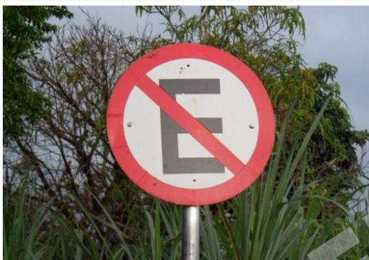
Foto ao entardecer, com iluminação natural reduzida, de dentro do veículo. Situação: Esta placa foi produzida com uma mistura de fundo pintado com tinta fosca e adesivos refletivos, caracterizada como semi-refletiva. Mesmo com a reduzida iluminação do horário do pôr-do-sol, a placa é identificável.
