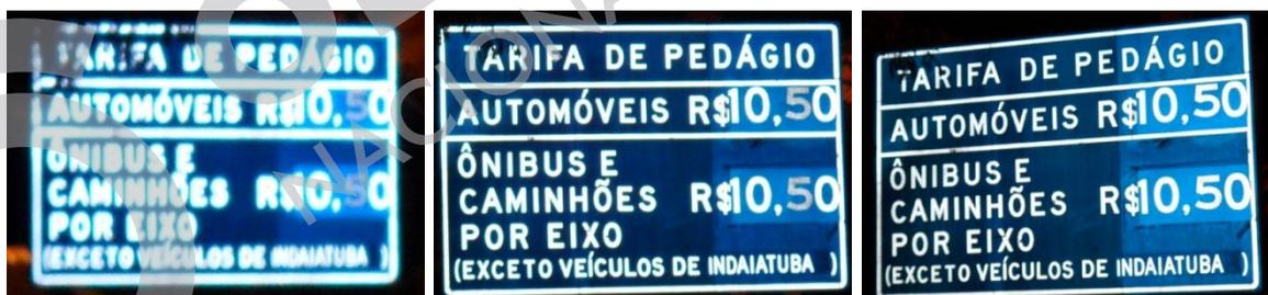
Conjunto de fotos noturnas, iluminadas pelo veículo, invertendo entre os fachos de luz altos e baixos. Situação: mostra as diferenças de reflexão, possivelmente pela instalação das letras em diversas direções.
