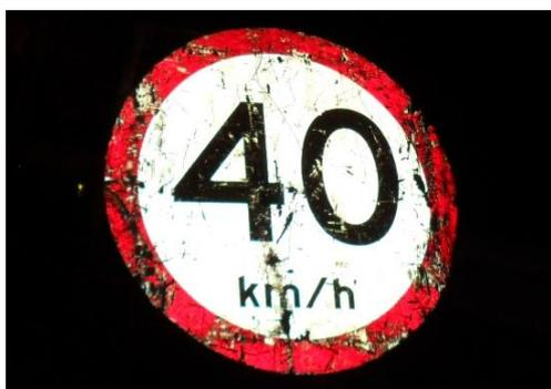
Foto noturna, iluminada pelos faróis. Situação: placa móvel usada em obras, riscada e deteriorada pelo uso e manuseio contínuo. Instalada em acesso a rodovia com obras.
