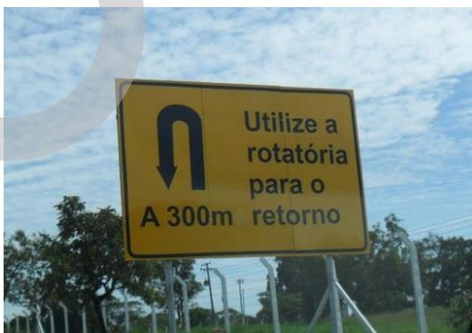
Foto diurna, iluminação natural. Situação: Apesar de visível e apropriada, o símbolo de retorno não é regulamentado nem pela sinalização de regulamentação e nem pela de advertência. Caberia aqui estudo para sua possibilidade de utilização, dado o número de casos passíveis de sua aplicação e aos exemplos de outros países que o adotam no uso corriqueiro.
